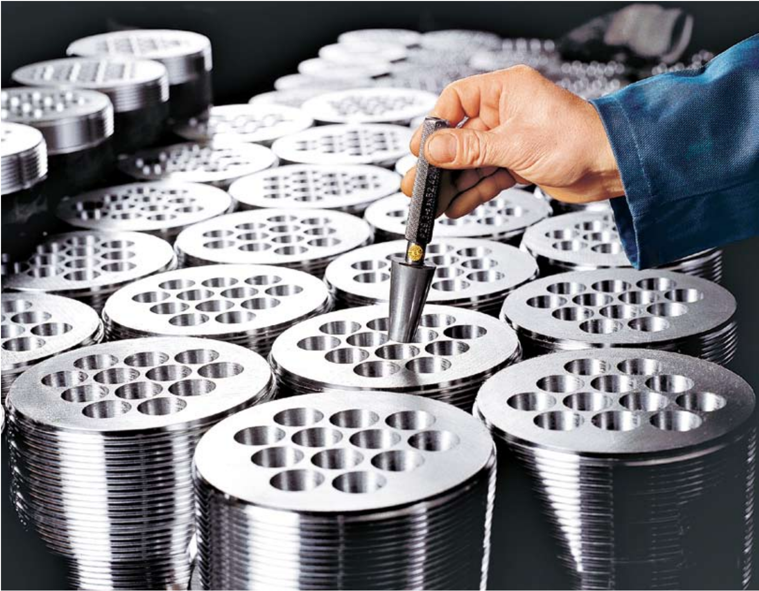
Kontrolle der Maßhaltigkeit der Bohrungen in der Ankerbüchse
