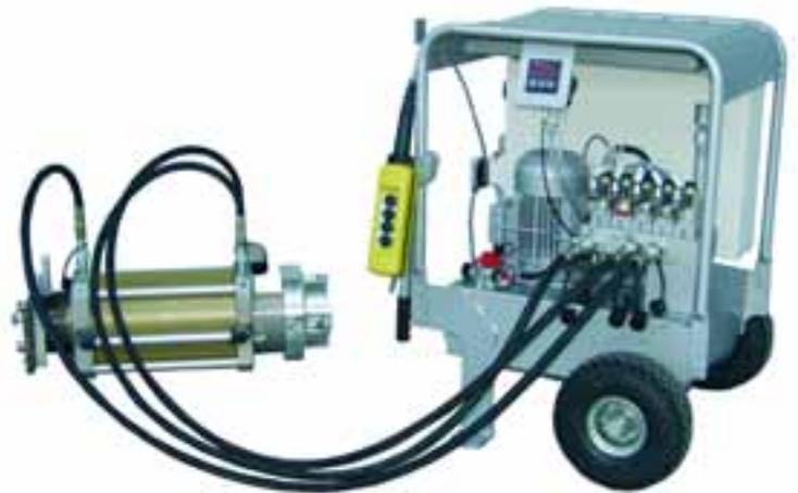
CFK-Leichtbauspannpresse mit Wegmess-System
