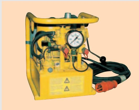
Hydraulikpumpe, Typ 77-159 A
